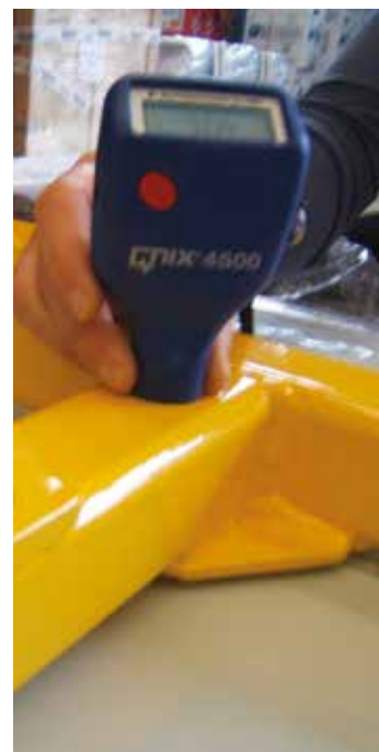
6 - Operazione di controllo dello spessore del film verniciante applicato con lo strumento Qnix 4500.
