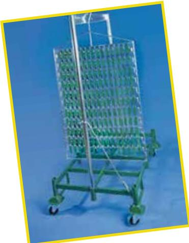
possibile da sopportare. In questo modo è stato possibile introdurre il minore ferro possibile. La piegatura a macchina dei ganci permette la sostenibilità dei pezzi anche con diametri minori rispetto ai telai prodotti artigianalmente.
