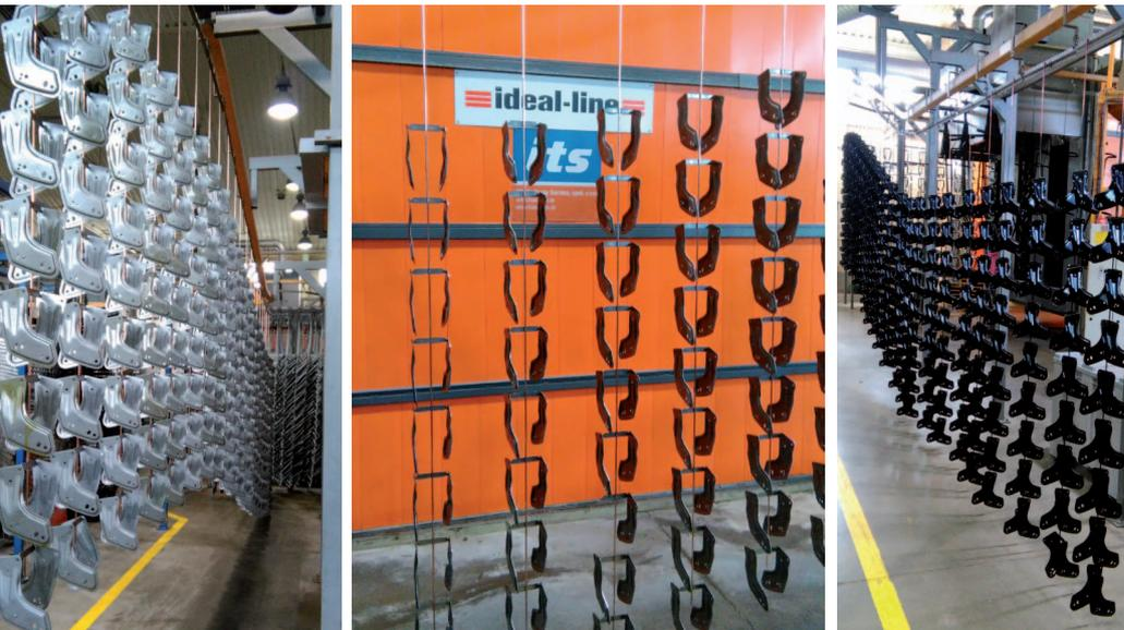
Effiziente Kleinteilaufhängung mit dem smarten HOS-System im Anlagenbetrieb umgesetzt.
